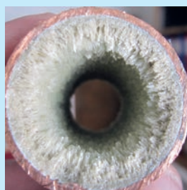
Kalkhaltiga avlagringar i bruksvattenrör.
