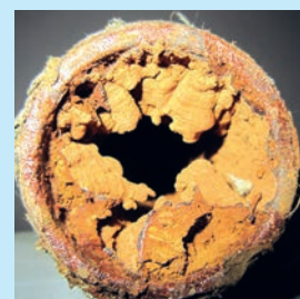
Rost- och kalkavlagringar i bruksvattenrör.
