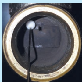
Radiatorventilens trånga passage.
